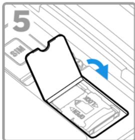
**Nota:** Siempre apague la computadora antes de intentar instalar o remover una tarjeta.
