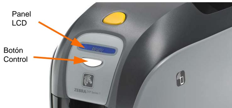
**Paso 3:** Mantenga presionado el botón Control y observe el panel de pantalla que muestra Initializing (Inicialándose) y CHECKING RIBBON (REVISANDO CINTA).
