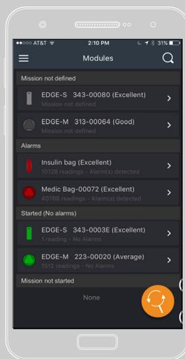
EDGEVue detecta automáticamente los sensores M-300 dentro del alcance de Bluetooth
