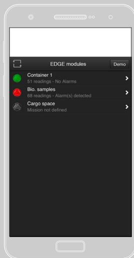
EDGEVue detecta automáticamente los sensores M-300-P dentro del alcance de Bluetooth
